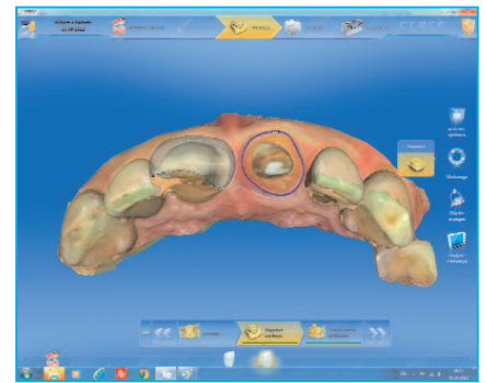
Abb. 3: Einzeichnen der Präparationsgrenzen im virtuellen Modell
