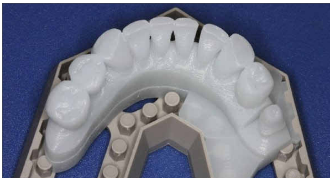
Abb. 4: Stereolithografisch gefertigtes Arbeitsmodell für die Zahntechnik. Foto: Straumann
