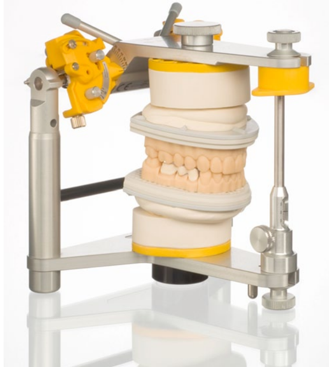
Abb. 9 ► Stereolithografisch gefertigtes Arbeitsmodell bei der Artikulation. (Mit freundl. Genehmigung von Sirona)
