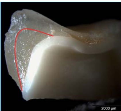
Abb. 2: Idealf orm der Höckerunterstützung schützt vor Verblendfrakturen Foto: Scherrer
