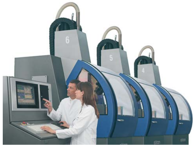
Abb. 2: Zur Bearbeitung von ZrO_2 -Keramik für Kronen- und Brückengerüste verfügen Fräszentren über eine ausgeklügelte Qualitätssicherung. (Foto: etkon-Straumann)
