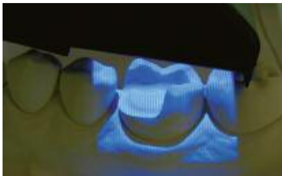
Abb. 2 Kurzweiliges Blaulicht mit Streifenlichtprojektion; System Cerec
