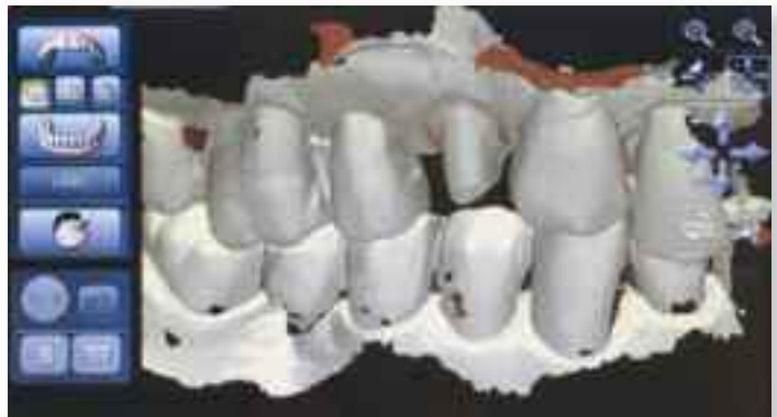
Abb. 1: Die videogeführte Intraoralabformung bietet ein virtuelles Modell und initiiert ein gefrästes zahntechnisches Modell. Mit der Software können komplexe prothetische Rekonstruktionen durchgeführt werden.
