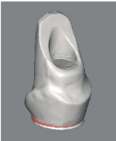
Abbildung 18 Virtuelle Abutment-Konstruktion mit Schraubenzugang zum Implantat.
