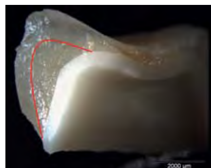
Abbildung 9: Eine fehlende Höckerunterstützung für die Verblendung erhöht das Chipping-Risiko.
