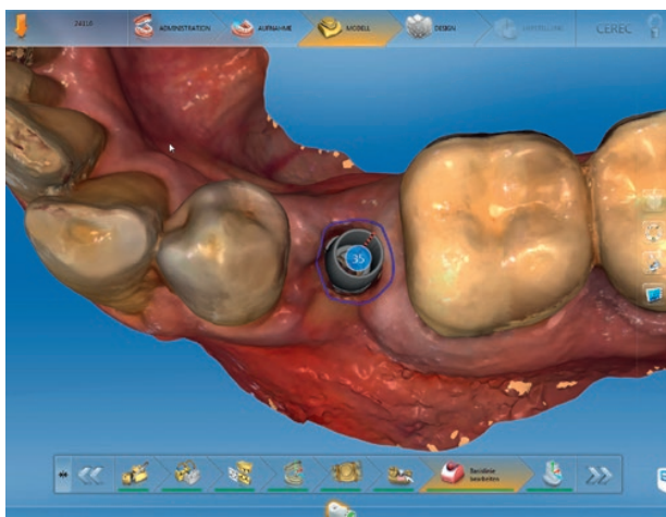
Abb. 2: Opto-elektronische Intraoralaufnahme des Scanbodys zur Übertragung der Implantatposition in das virtuelle Modell und zur Konstruktion der prothetischen Suprastruktur Foto: AG Keramik
