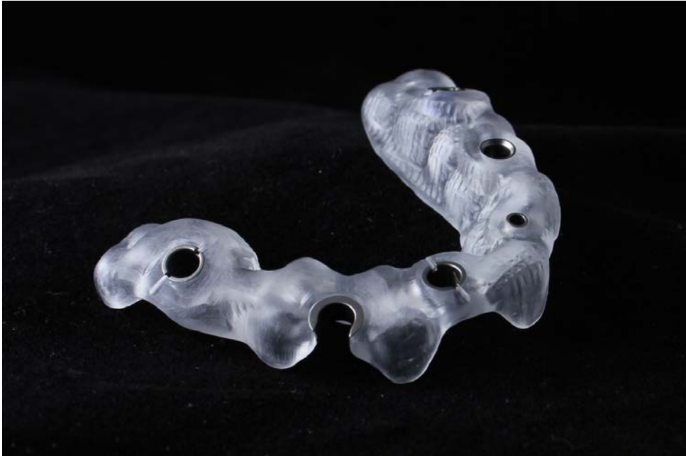
Abb. 7: Chirurgische Bohrschablone zur Platzierung von Implantatpfeilern, gefertigt auf Basis von DICOM-Daten aus dem DVT. Der PMMA-Werkstoff wird 5-achsig ausgefräst mit Wandstärken von 2-3 mm. Die Konstruktion mit Bohrhülsen zur definierten Instrumentenführung ermöglicht verschiedene Angulationen der Enossalpfeiler. Quelle: Sicat
